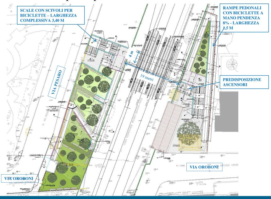
Sottopasso veicolare di via Pesaro **FANO STRADE** VIA PESARO RAMPA OVEST **ARROCCAMENTO PENDENZA 7% SOVRAPPASSO** STRADALE PER **MANTENIMENTO** VIA A. DA **BARBIANO** VIA A. DA BARBIANO **RAMPA EST PENDENZA MASSIMA 7,2% COLLEGAMENTO** PEDONALE TRA VIA PANTALEONI E VIA A. DA BARBIANO (E LA **PARCO FERMATA DI NORD BRUZZANO**) **COLLEGAMENTO SOLO CON VIA PANTALEONI E VIA MARTINAZZOLI**
